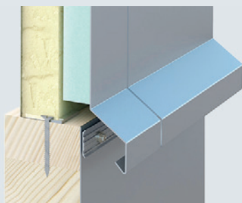
Montage vertical sur une couronne de madriers
