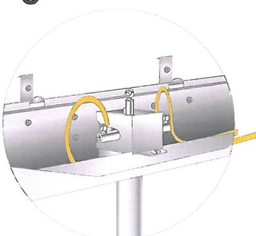
**9** Visser la tige du vérin sur la traverse du bloc mécanisme
