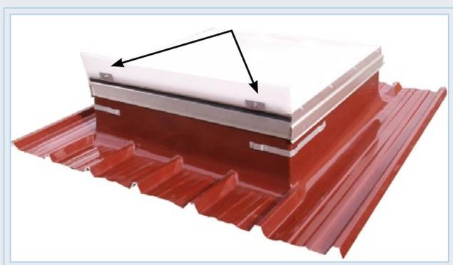
**1.** Positionner la bande de polycarbonate dans les pattes situées à l'avant du capot, puis la fixer avec des vis autoforeuse de 6,3 x 35 mm
