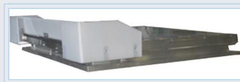
**2.** Positionner et fixer avec des vis autoforeuses 6.3 x 25 mm les 2 déflecteurs angulaires. La partie biaisée doit se trouver sur les côtés, et les supports des fixations en appui sur le talon de la coiffante.
